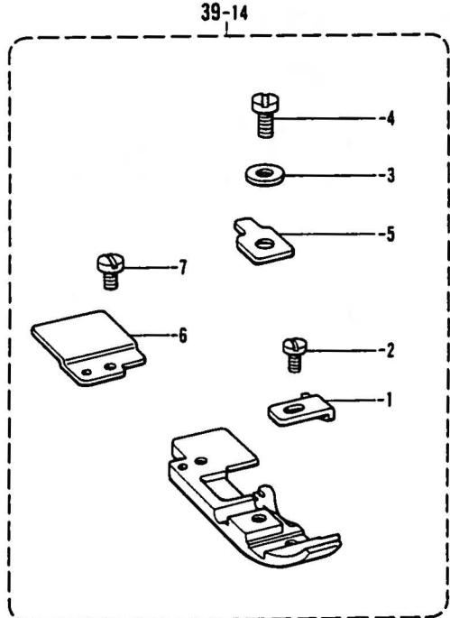
E. 押工関係/Presser foot mechanism/Stoffdrückerfuß/
