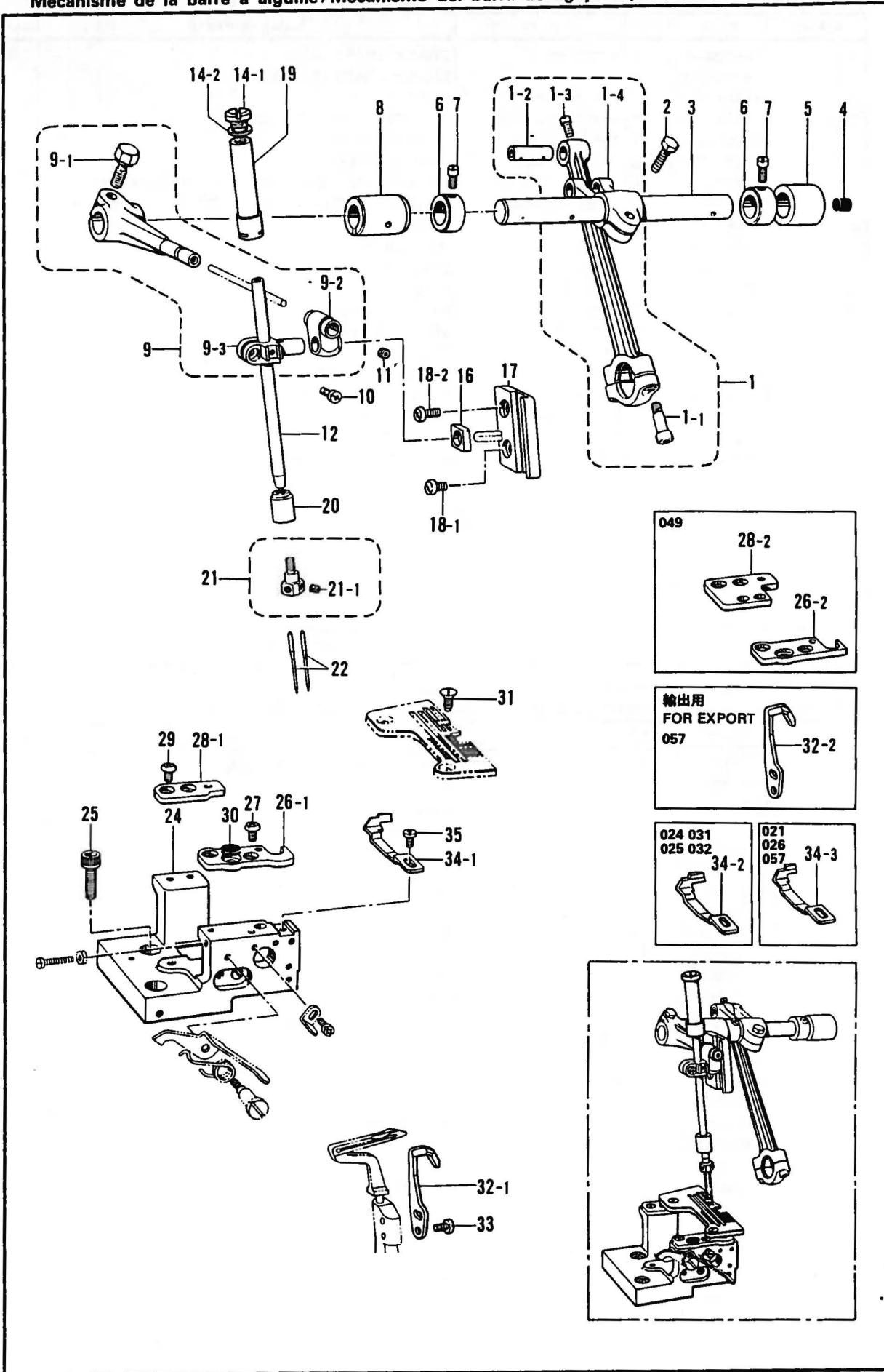
D. 針棒関係 / Needle bar mechanism / Nadelstangenvorrichtung /
