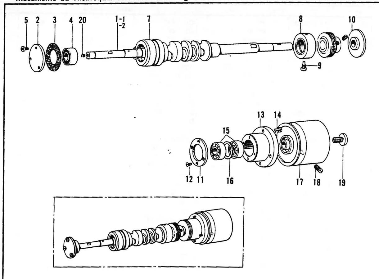
C. 針冷却装置/Needle cooler/Nadelkühlungsvorrichtung/
