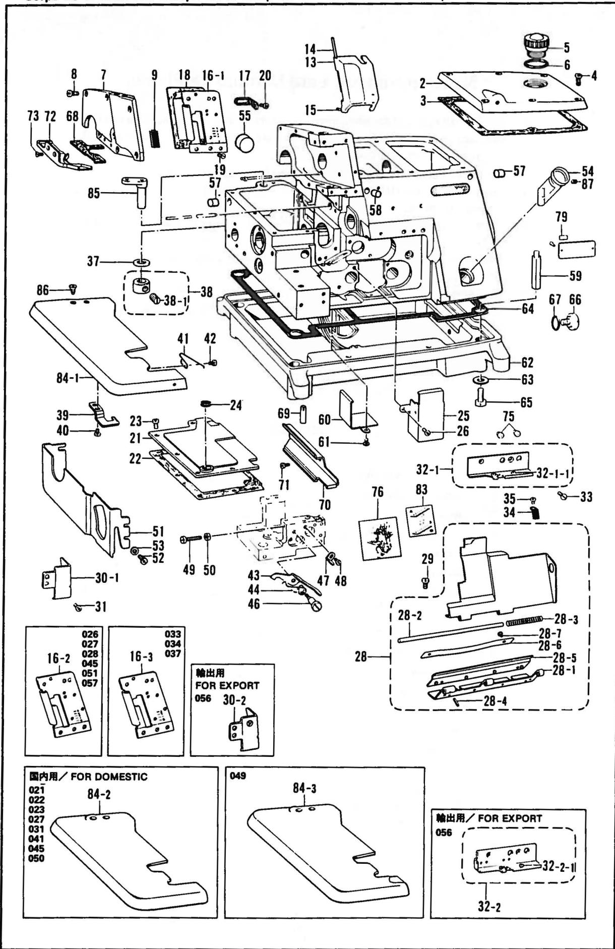
A. フレーム関係/Machine body/Maschinengehäuse/
